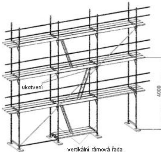
Obr. 9 Pole lešení s předsazeným žebříkovým výstupem (délka pole pouze 2,0 m – třída zatížení 5)
