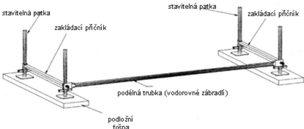
Obr. 2 Vyrovnaní nejnižšího podlaží lešení pomocí zakládacího příčníku a podélné trubky (vodorovného zábradlí)
